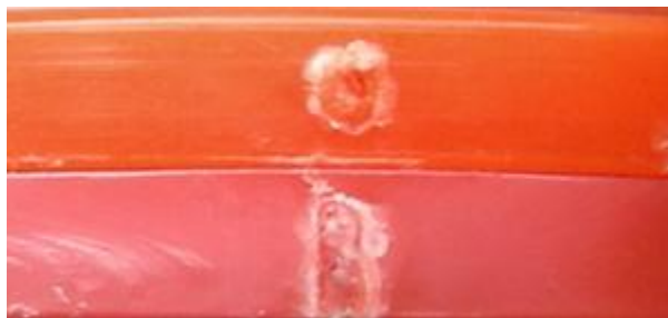
Илл. 3. Сравнение форм литников (в верхней части фотографии – литник на гурте жетона, изготовленного в мастерских метрополитена, в нижней части фотографии – литник на гурте жетона, изготовленного на предприятии ХАРТРОН)
